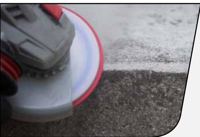
I dischi semi-flessibili CP FLEX sono realizzati con un supporto in fibra molto resistente al quale è applicato uno strato multiplo di abrasivo al Carburo di silicio.
