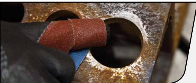
**GF71 di GRINDING** è un prodotto di altissima qualità. Il supporto in tela in cotone molto flessibile e resistente consente operazioni di levigatura sia su superfici piane che sagomate; ottimo il suo impiego su particolari in acciaio e metallo, per la rimozione di ossidi e per la finitura di parti meccaniche, indicato anche per la lavorazione di superfici in legno e legno verniciato.
