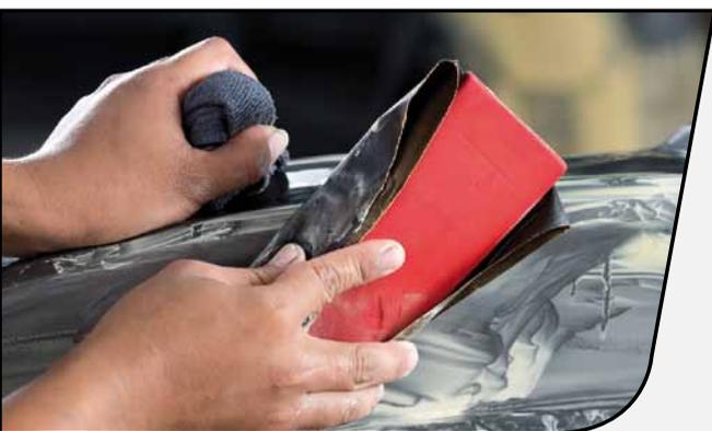
Per uso con tamponi o a mano, **GW91** di **GRINDING**, progettato con abrasivo in Carburo di Silicio risulta la soluzione più indicata per operazioni di levigatura e finitura a secco o ad umido, su superfici verniciate, stucchi, ceramiche, vetro, plastica, marmo e materiali compositi.
