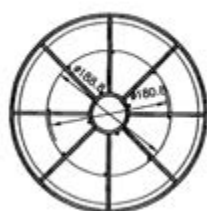
Bobina 69 non rivestita Cestello metallico Foro dia. 51 mm (non necessita di adattatore) Filo spira-spira EN 759: BS300
