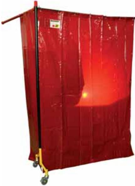
La nuova struttura è costituita da tubi in acciaio da 32 e 22 mm di diametro, con giunti di precisione che assicurano la necessaria stabilità. L'elemento standard ha una base di 70 cm, con piedini di gomma. Questo consente, con due elementi, di formare una struttura ad angolo di 90 gradi, o con 4 elementi, di formare una struttura chiusa a cubo.
