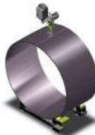
Saldatura longitudinale esterna ad arco sommerso con manipolatore a colonna
